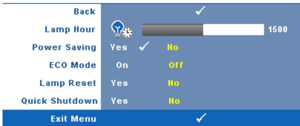
**LAMP HOUR (DURAÇÃO DA LÂMPADA)**—Mostre o tempo de funcionamento desde a última redefinição do temporizador da lâmpada.
